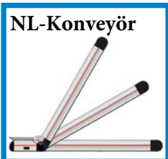
Tüm standart MTF Multi-Tech açılı konveyörler için, konveyör açıları 0° ile 60° arasında sürekli olarak ayarlanabilir.
