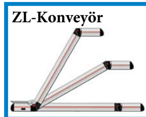
Tüm standart MTF Multi-Tech açılı konveyörler için, konveyör açıları 0° ile 60° arasında sürekli olarak ayarlanabilir.
